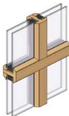
Petits bois mortaisés Petit bois mortaisé largeur 53 mm. Il est assemblé par tenon dans le vantail. C'est le petit bois traditionnel adapté aux normes actuelles.
